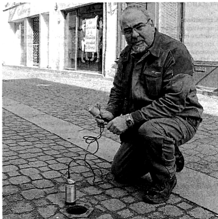
Alain Poivre, de Véolia, met en place l'appareil qui permet de traquer les fuites.
